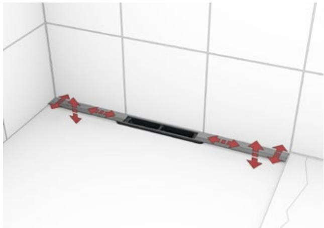
**Paso 6:** El perfil de ducha permite un ajuste de precisión vertical y horizontal, incluso después de montar el sumidero en el solado. Además, también se puede adaptar a los diferentes grosores de las paredes y los revestimientos de suelo.
