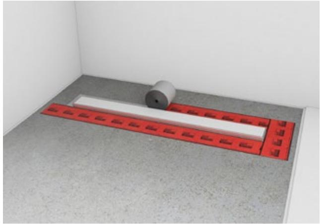
**Paso 3:** Se pega la cinta de sellado Seal System de forma que solape la brida de la canaleta de ducha y el solado.
