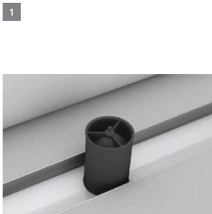
Innovación frente a los olores: el bloqueo antiolores con membrana de dos capas reduce al mínimo la evaporación del agua del sellado en el sifón, al mismo tiempo que actúa como barrera para los insectos. El candidato perfecto para aquellas duchas que apenas se usan.
