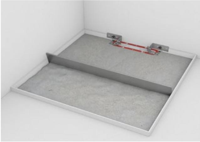
**Paso 3:** El solado debe aplicarse con una pendiente de entre 1 y 2 % con respecto a la pared. La protección para pared de obra montada de fábrica protege el sumidero ante daños y suciedad.
